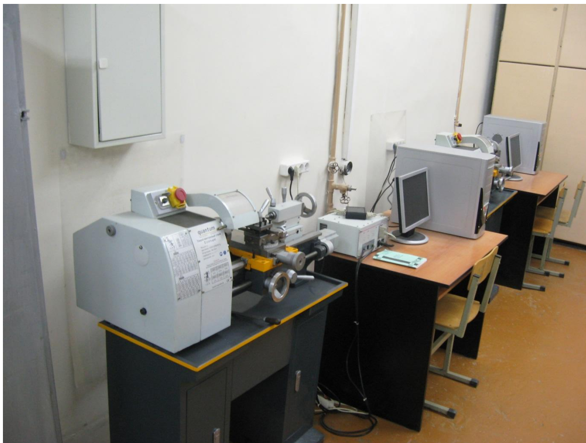
Рис. 5. Токарные станки Quantum D210x400 с системой ЧПУ MEGA NC
