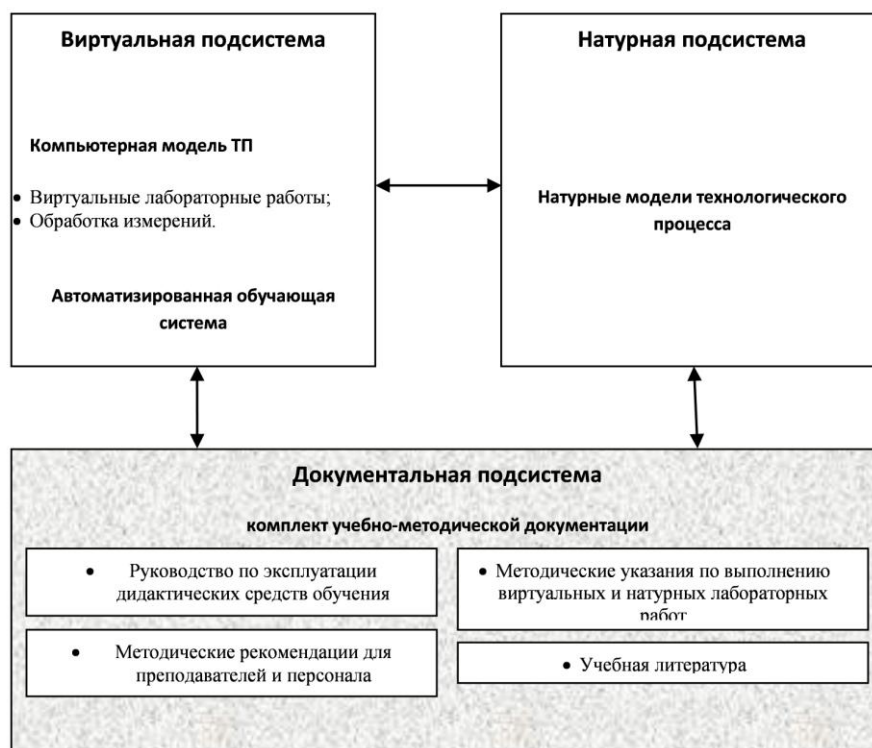
Рис. 1. Укрупнённая структурная схема виртуально-натурного обучающего комплекса
