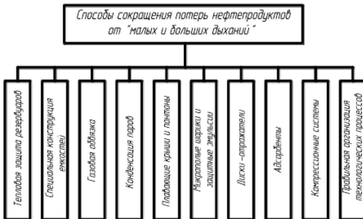
Рис. 1. Способы сокращения потерь нефтепродуктов от испарения
