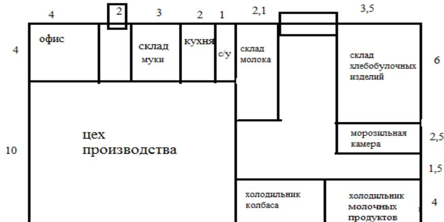
Схема № 2. План производственного и складского помещения
