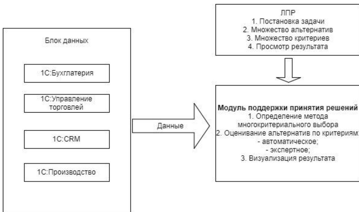
Рисунок 2 – Модель информационной системы поддержки принятия решений
