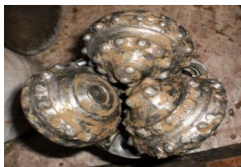
Рис. 3. Долото с разрушенным вооружением шарошек
