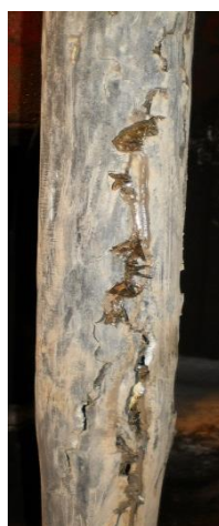
Рис. 2. Трещина и разрушения в бурильной трубе после торпедирования в скважине № 308 ЮОК
