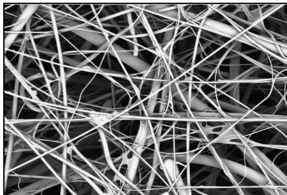
Рис. 3. Строение НЕРА-фильтра под микроскопом [8]
