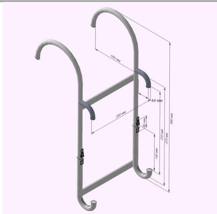
Рис. 2. Устройство для повышения тактико-технических характеристик штурмовой лестницы
