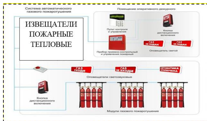
Рис. 2. Принципиальная схема автоматической газовой системы пожаротушения стана «2300»
