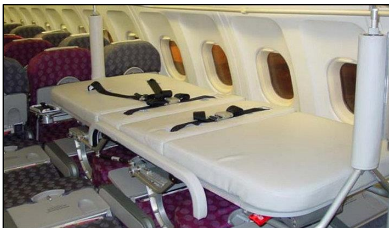
Рис. 7. Специальные носилки для перевозки пассажира в лежачем положении на борту воздушного судна типа Airbus A320
